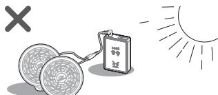
\*発熱、発火、破裂の原因およびプラスチック部品が変形し故障の原因になります。
