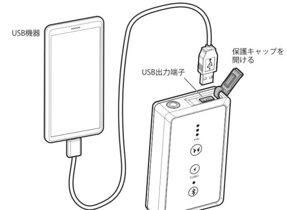
2. 本製品の電源ボタンを約3秒間長押しすると、電源がONになり、USB機器への出力を開始します。
